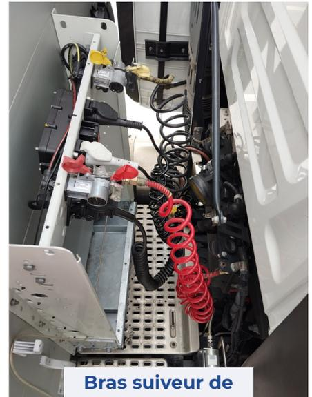
Bras suiveur de raccordement des flexibles
